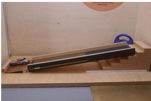
Abbremsen von Carrera-Autos auf einer schiefen Ebene durch Einschieben von Platten verschiedener Materialien
