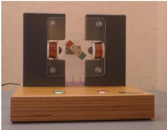
Steuerung von Elektromagneten eines zweipoligen Elektromotors mit einem Permanentmagneten als Läufer
