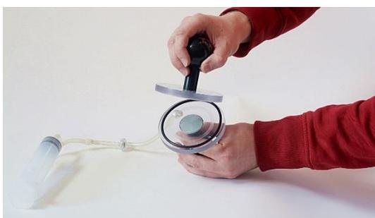
Herauspumpen der Luft aus dem Hohlraum zwischen zwei Plexiglasplatten
