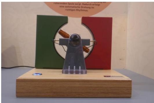
Demonstration der automatischen Umschaltung der Stromrichtung durch einen Kommutator mit Schleifkontakt
