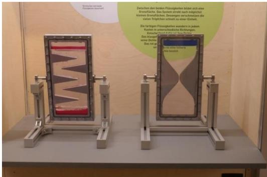
Trennung nicht-mischbarer Flüssigkeiten in Drehkästen
