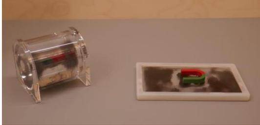
Das Magnetfeld eines Stabmagneten wird 2- und 3-dimensional demonstriert.
